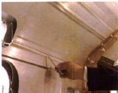
Electrostar系列列车内部的搅拌摩擦焊焊缝
