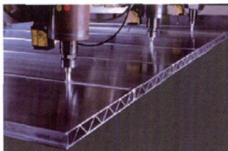
列车铝合金型材的搅拌摩擦焊焊接过程
